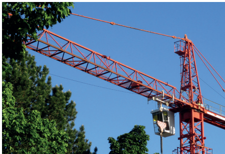
Ein Beispiel für eine Konstruktion aus Fachwerk: Ein Kran (Quelle: M. Schildmann)
